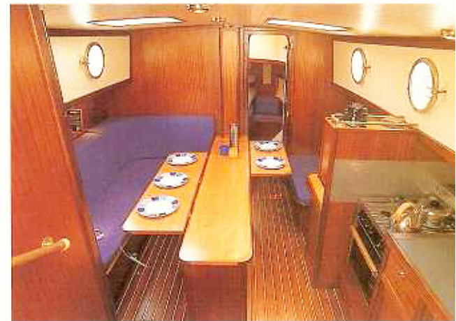
Onder: Op de bovenkant van de zwaardkast is de kajuitafel geplaatst. De tafel heeft een wat afwijkende vorm, maar je kan er wel voldoende op kwijt. Met de bladen naar beneden geklapt, is de zwaardkast geen sta-in-de-weg in het interieur.
